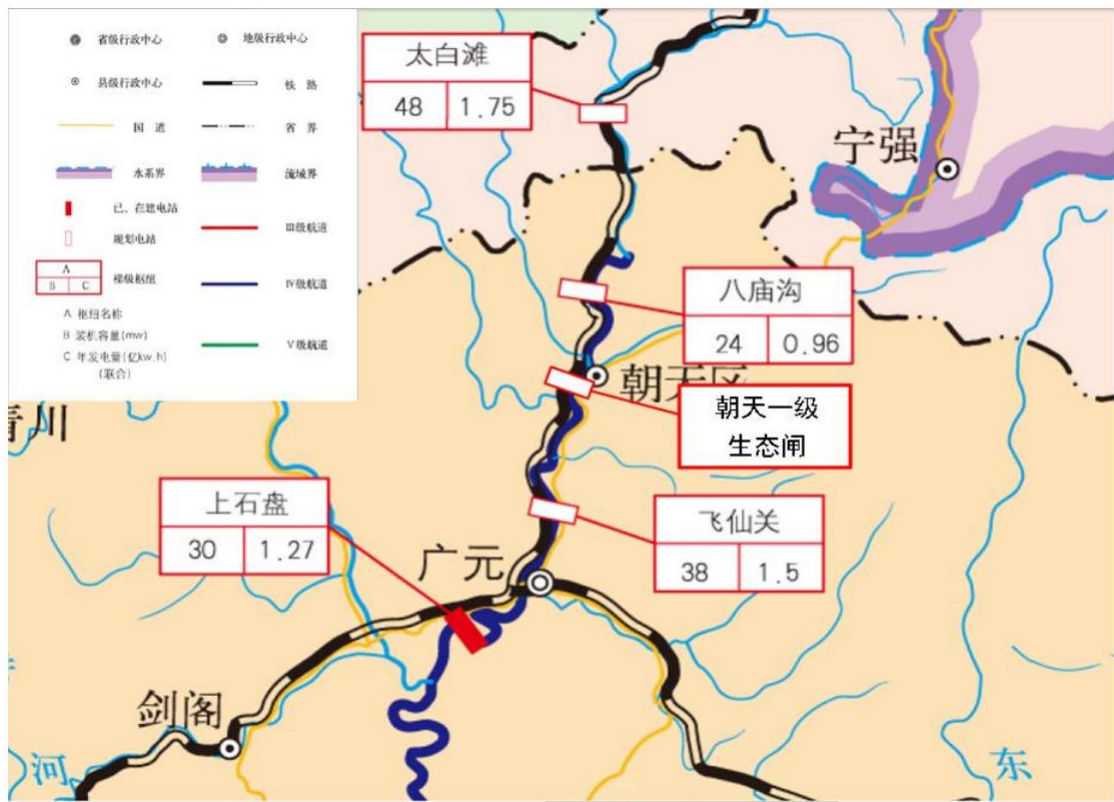
图 2.7-1 朝天一级生态闸坝与河段梯级开发规划的关系平面示意图
