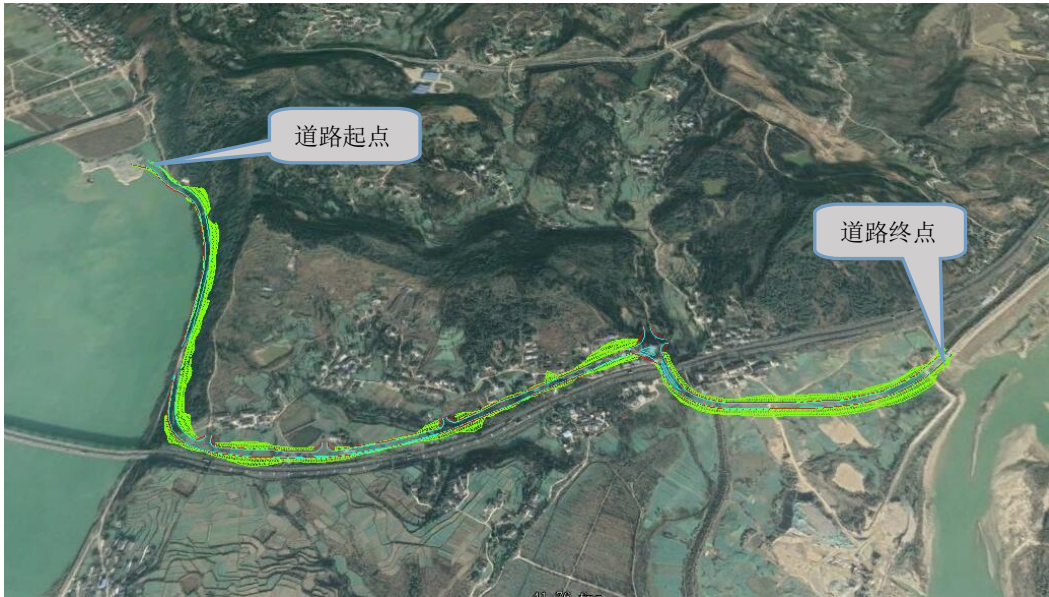
图 1-3 坪雾坝——土基坝段线路走向示意图
